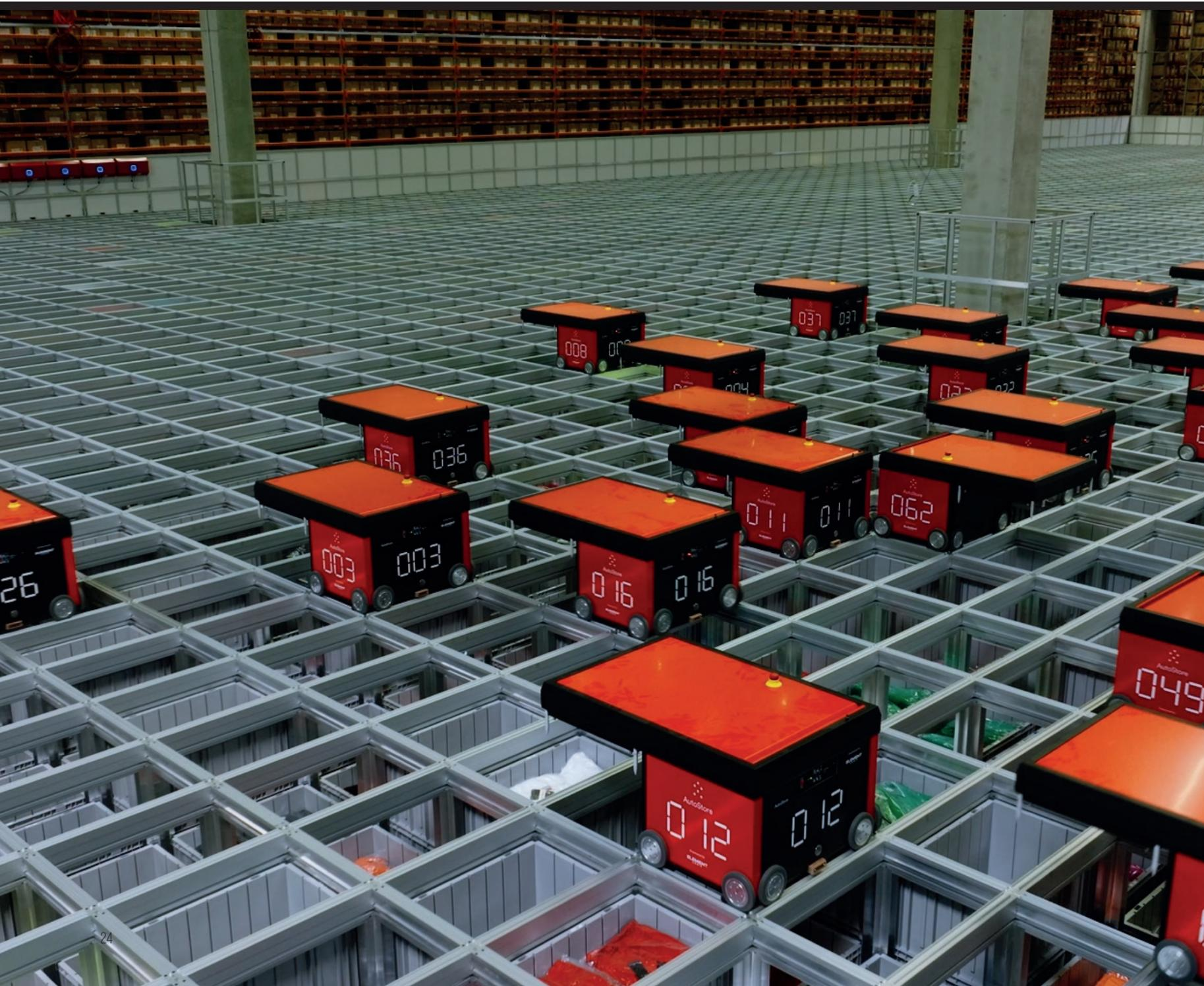
Dank der Installation des AutoStore-Systems konnte die Lagerkapazität des 2 650 m<sup>2</sup> großen Lagers um bis zu 20 % erhöht werden. Zu den weiteren wichtigen Vorteilen gehören eine 34%ige Verringerung der Fehlerquote, eine schnellere und höhere Versandkapazität, geringere Energiekosten und eine genauere Auftragsabwicklung.
